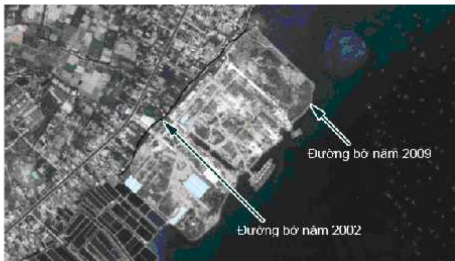
Hình 9. Công trình l n bi n c a Nhà máy óng tàu Cam Ranh
